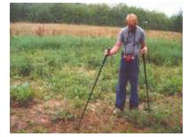
为了确定涂层缺陷的性质,如严重性、形状、腐蚀情况等,检测者可在这一带进行各种电气测量。
