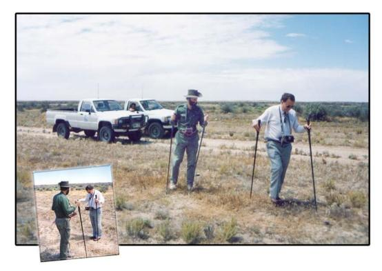
20世纪80年代早期,约翰·慕瓦尼(John Mulvany)与约翰·利兹(John Leeds)博士在澳大利亚沙漠地带进行直流电压梯度检测技术(DC Voltage Gradient Technique)实验;当时该技术尚处于早期开发阶测试阶段。
