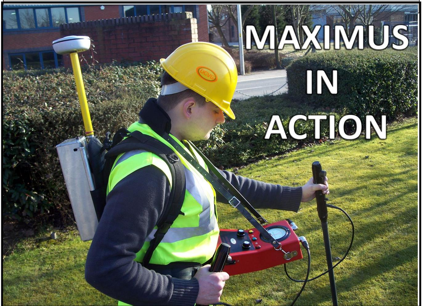
我们将该设备命名为“Maximus”，以表明模拟DCVG地管涂层检测技术已迈出了最重要的一步。在该设备的辅助下，地管检测的便利性与准确性将大大提高
