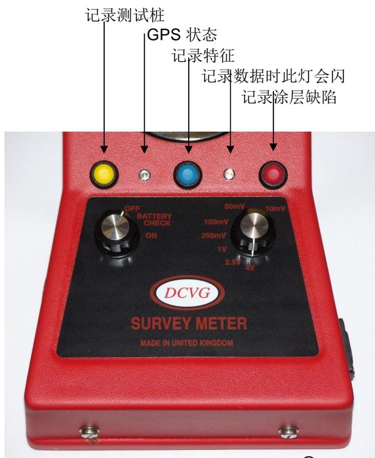
记录数据时，设备会发出声音信号。当接收不到GPS信号时，GPS指示灯会熄灭；而信号无效时，指示灯则会闪动。GPS天线、DGPS电子设备及其电池置于背架处。为使定位精度达到最高（10到15cm），GPS系统需登录本地基站或租用卫星信号。
