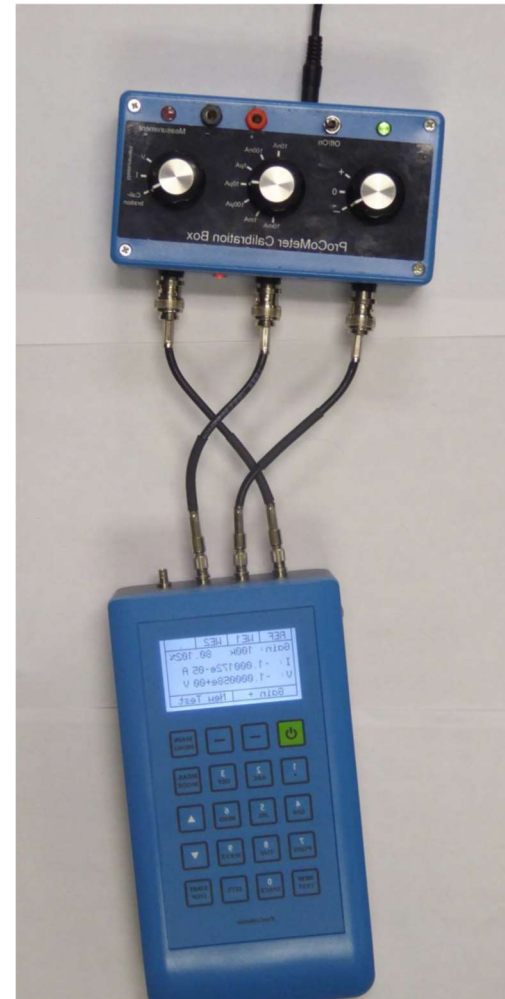
ProCoMeter 和校准盒子连接在一起
